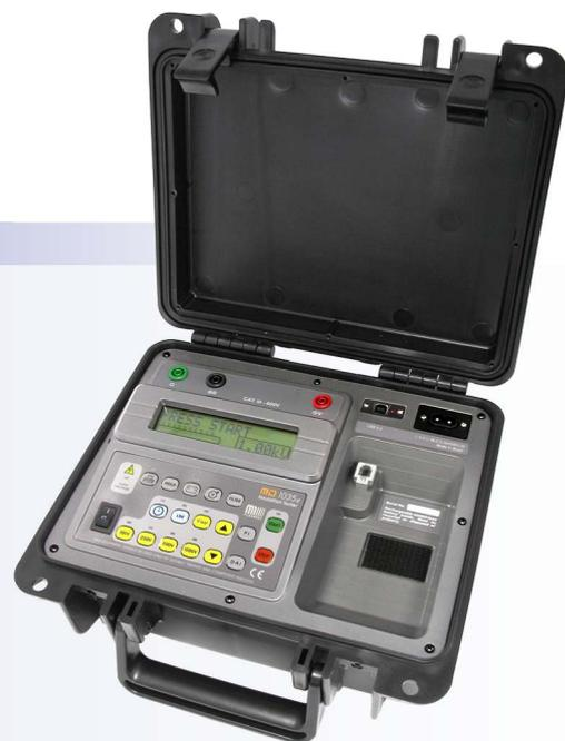
O megôhmetro digital MEGABRAS modelo **MD-1035e** é um equipamento de grande versatilidade, inteligente, fácil de usar. Utiliza uma tecnologia experimentada, de grande eficácia que fornece medições confiáveis, seguras e precisas de resistências de isolamento de até **1.000.000MΩ @ 1kV**, com 4 tensões de prova pré-selecionadas: **100V - 250V - 500V - 1000V**. Qualquer outra tensão entre 100V e 1kV poderá ser selecionada em passos de 50V.
