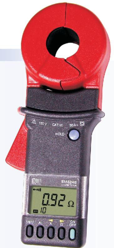
El medidor de resistencia de tierra **EM-5248** mide la resistencia de un sistema de puesta a tierra formado por jabalinas o mallas pequeñas mediante la medición de la resistencia de un lazo de tierra aprovechando la presencia de puestas a tierras vecinas, sin necesidad de utilizar jabalinas auxiliares propias y sin desconectar la puesta a tierra bajo ensayo.
